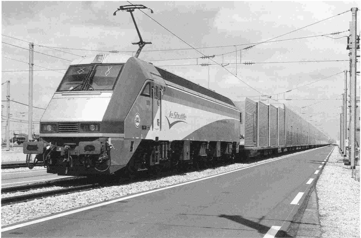
L'Euro-Shuttle, qui tire les convois lourds sous la Manche, est équipé de nombreux condensateurs.
